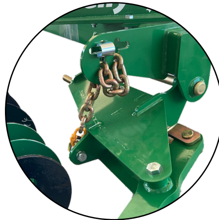
Aukščio reguliavimo grandinės ir plokštelės su prapjovomis
