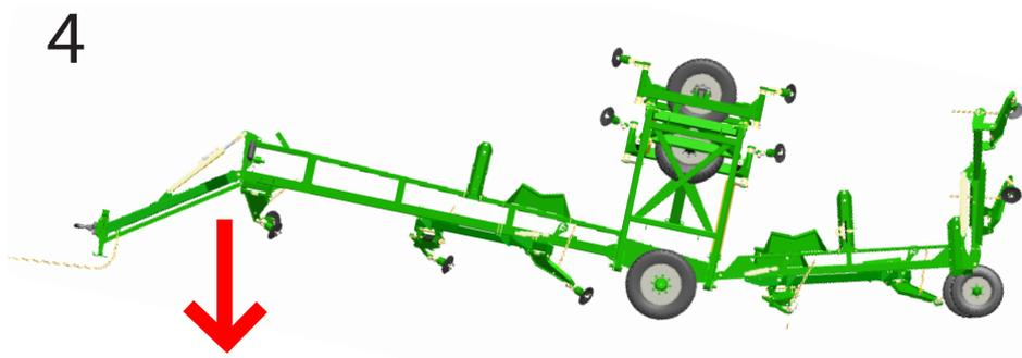
б. Разложите крылья, удерживая гидравлический рычаг, пока штоки гидравлических цилиндров центральной рамы не будут центрированы в своих пазах.
