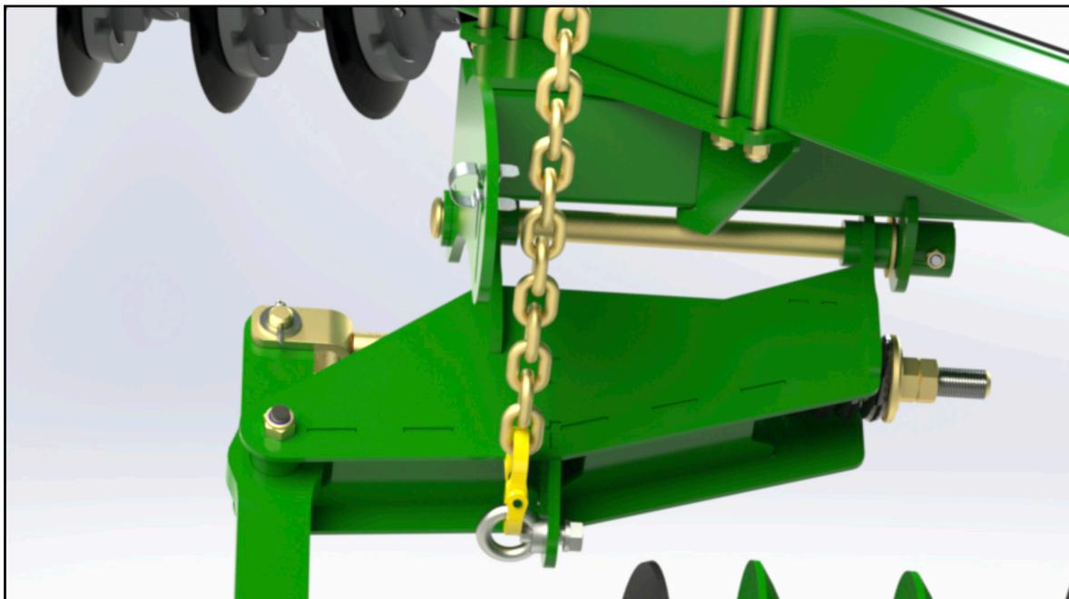
Конец корпуса узла натяжения
