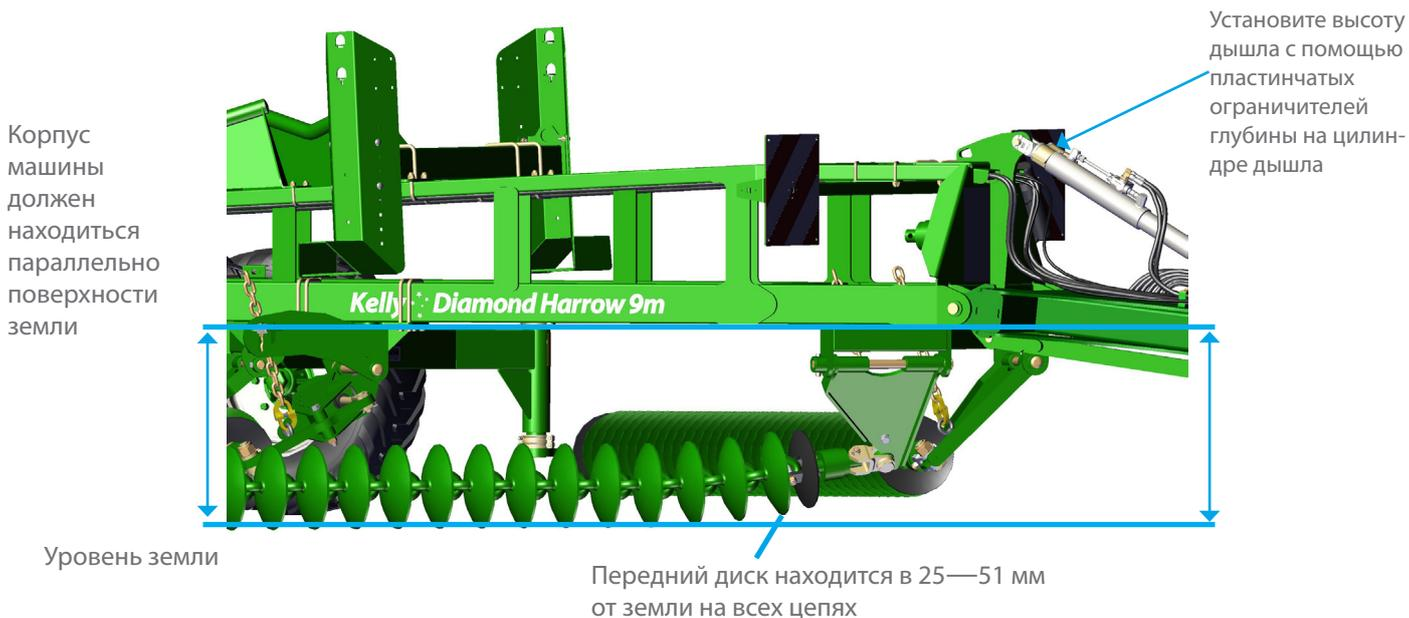
Проверьте длину цепей регулировки высоты на двух передних крепежных пластинах цепей. В цепи не должно быть слабину, а также должен оставаться просвет около 25—51 мм между землей и низом первого диска.
