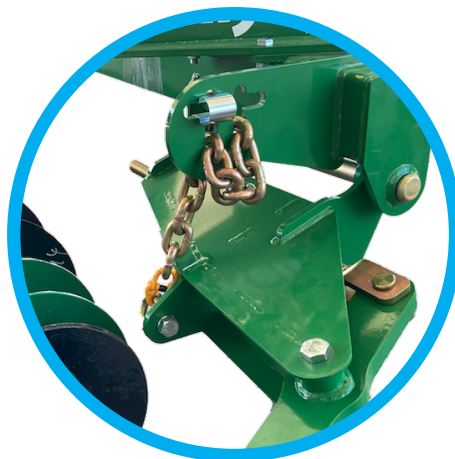
Řetězy nastavení výšky a desky s otvory
