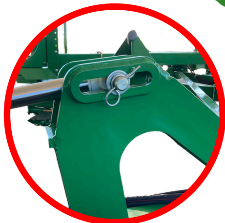
Hydraulikzylinder-Bolzen am Mittelrahmen
