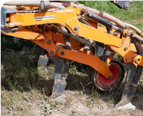
Das Saatgut wird mit hydraulisch in der Tiefe verstellbaren Zinken im Boden abgelegt.
